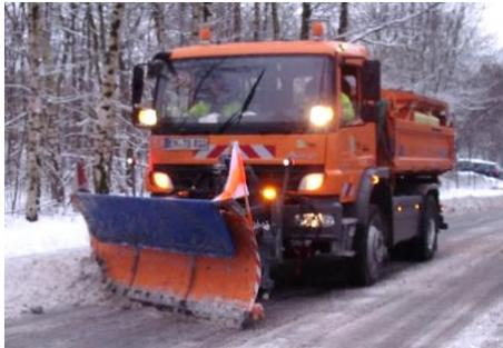
Für den Winterdienst werden bis zu sechs Fahrzeuge mit Schneeschiebern bzw. Schneeschiebern und Streuvorrichtung ausgerüstet. Zusätzlich werden bis zu vier Fahrzeuge von den Handstrettruppen genutzt.
