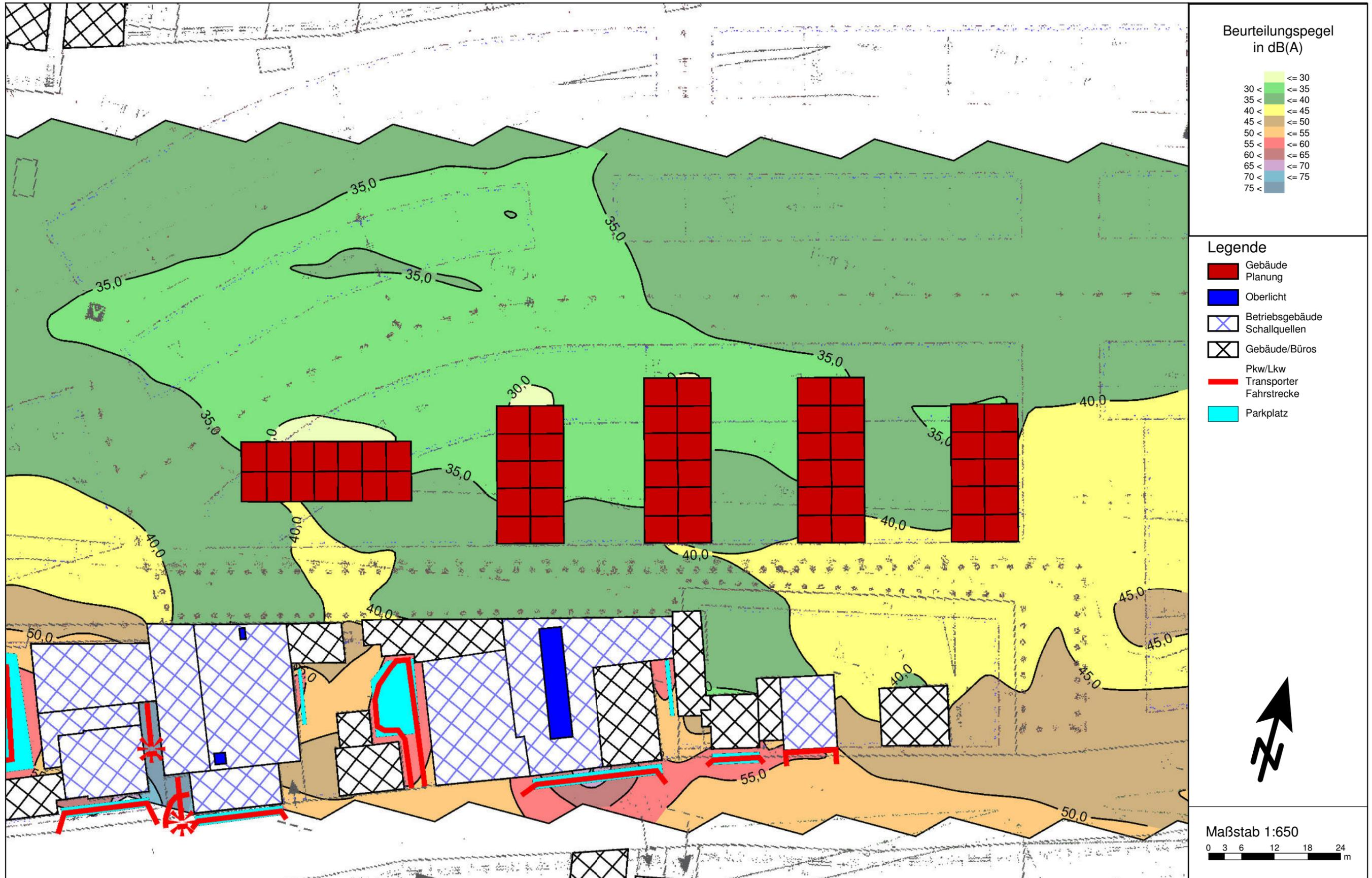
Ergebnis der Immissionsberechnungen gemäß TA Lärm – Isophonendarstellung für eine Rechenhöhe h=1,5m ü. G. (Erdgeschoss)
