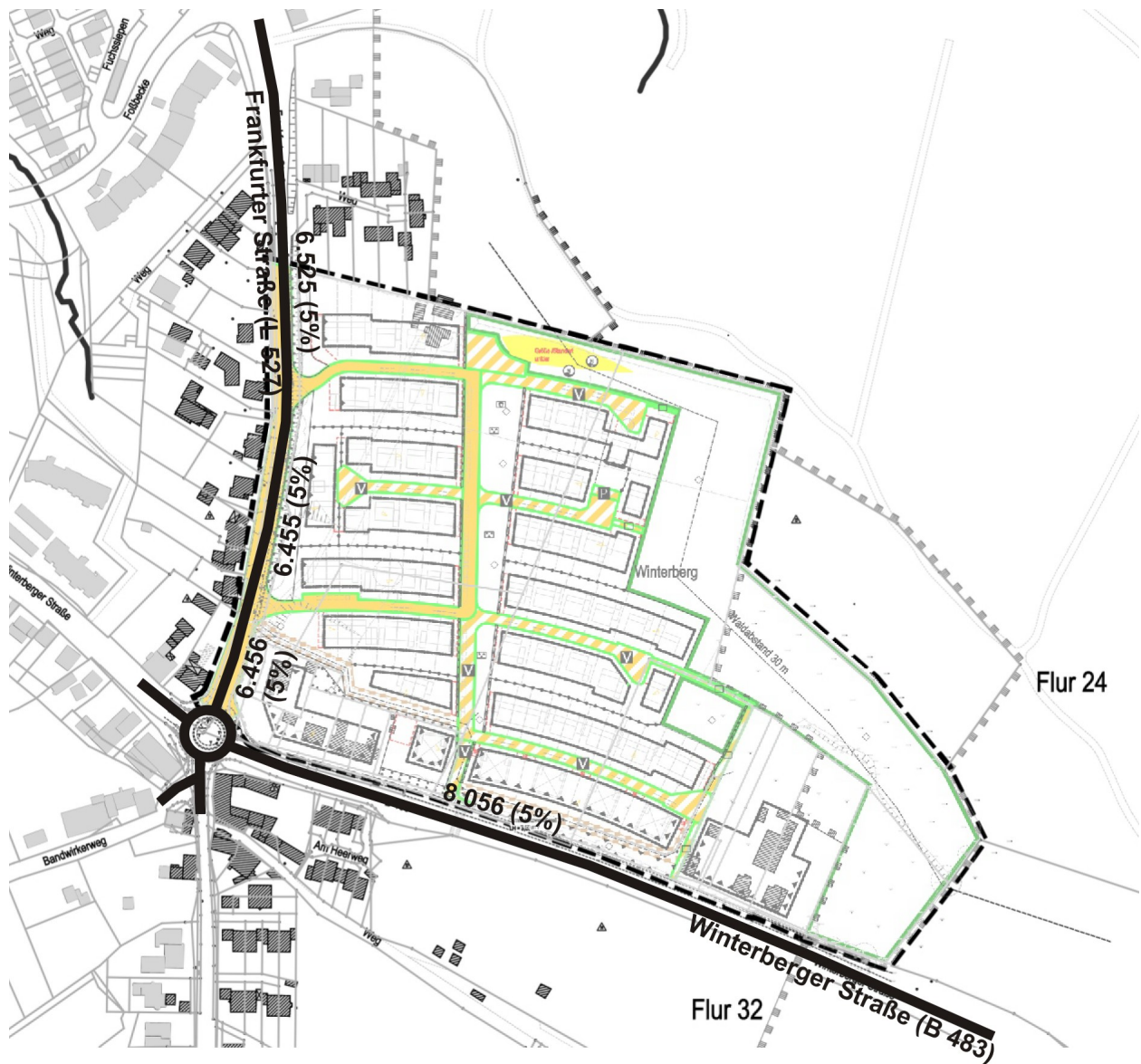
Abbildung 4 : Verkehrsstärken im öffentlichen Straßennetz im Prognose-Planfall mit der geplanten Nutzung [Kfz/24h (SV%)]
